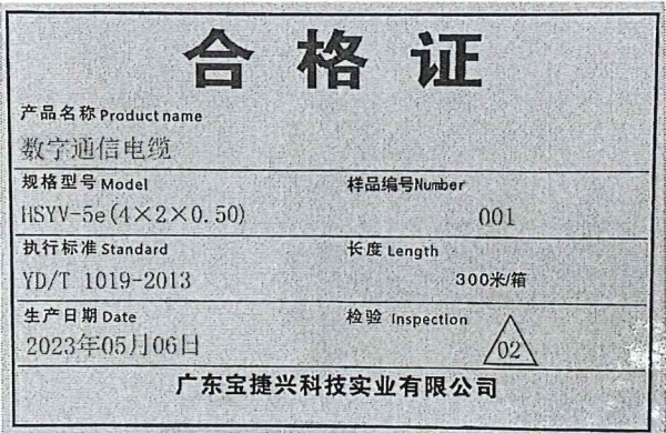
图 2 HSYV-5e 数字通信电缆（4×2×0.50）（铭牌）
