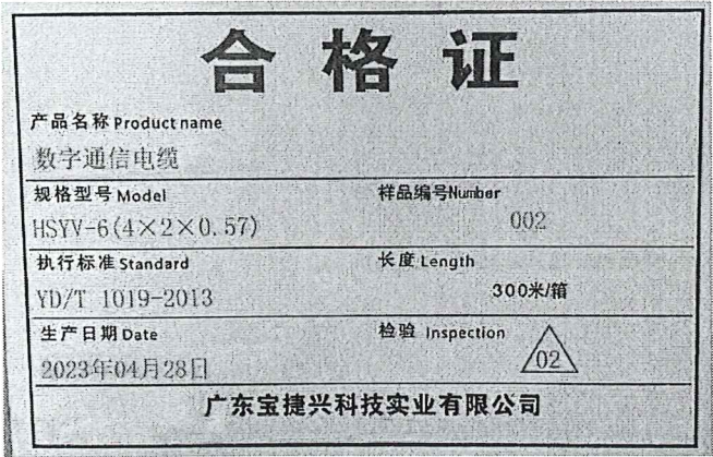
图 2 HSYV-6 数字通信电缆（4×2×0.57）（铭牌）
